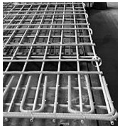
Kunststoff anstelle von Stahl als Bewehrung.
